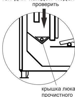
**Внимание!** Неправильная установка крышки люка прочистного (Рис.1. поз.32) приводит к прогоранию и деформации водонехолаждаемых поверхностей котла. В случае нарушений условий эксплуатации котла рекламации не принимаются.
