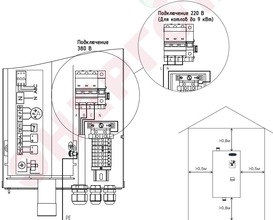
**Рис.3 Схема подключения котла**
