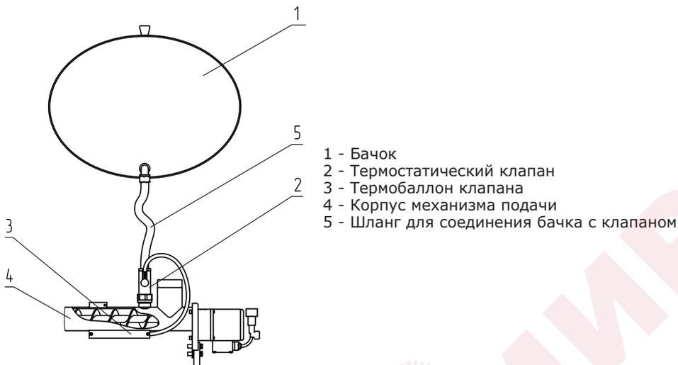
**Рис.5 Система охлаждения топливопровода**
