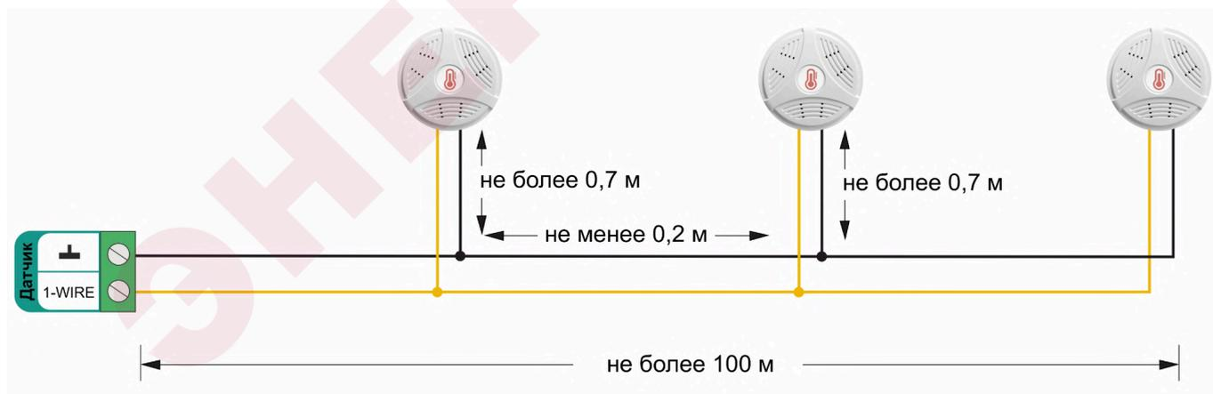
Подключение датчиков по трехпроводной схеме:
