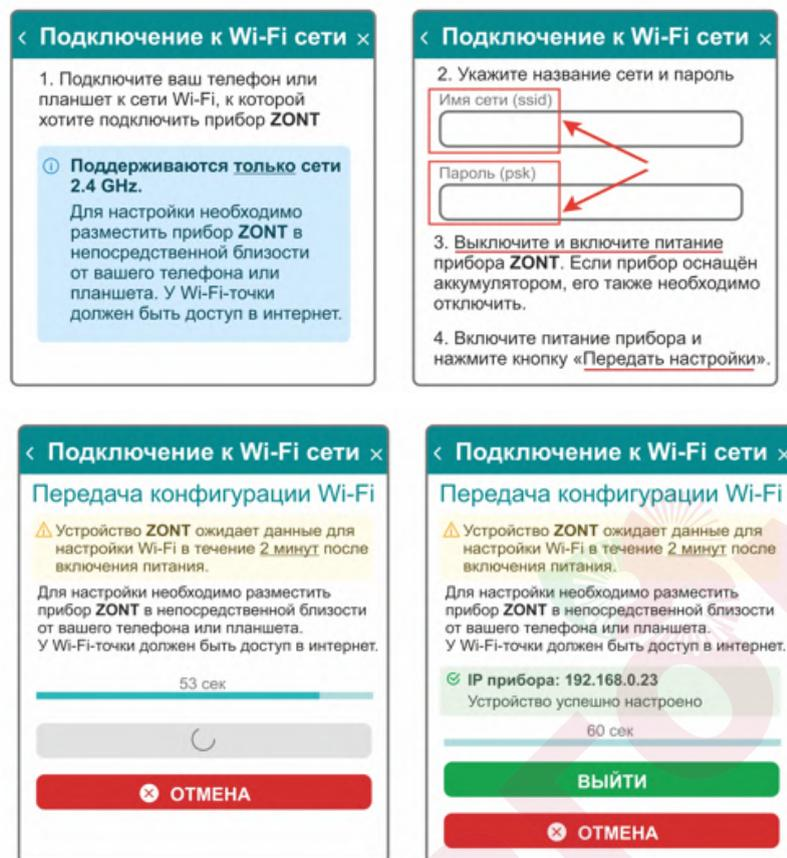
**ВНИМАНИЕ:** Смартфон с приложением ZONT нужно подключить к той же сети Wi-Fi, в которой будет работать Контроллер. Роутер должен быть настроен на работу в диапазоне 2,4 ГГц и раздавать интернет в режиме "router" (режимы "мост"/"bridge" непригодны).
