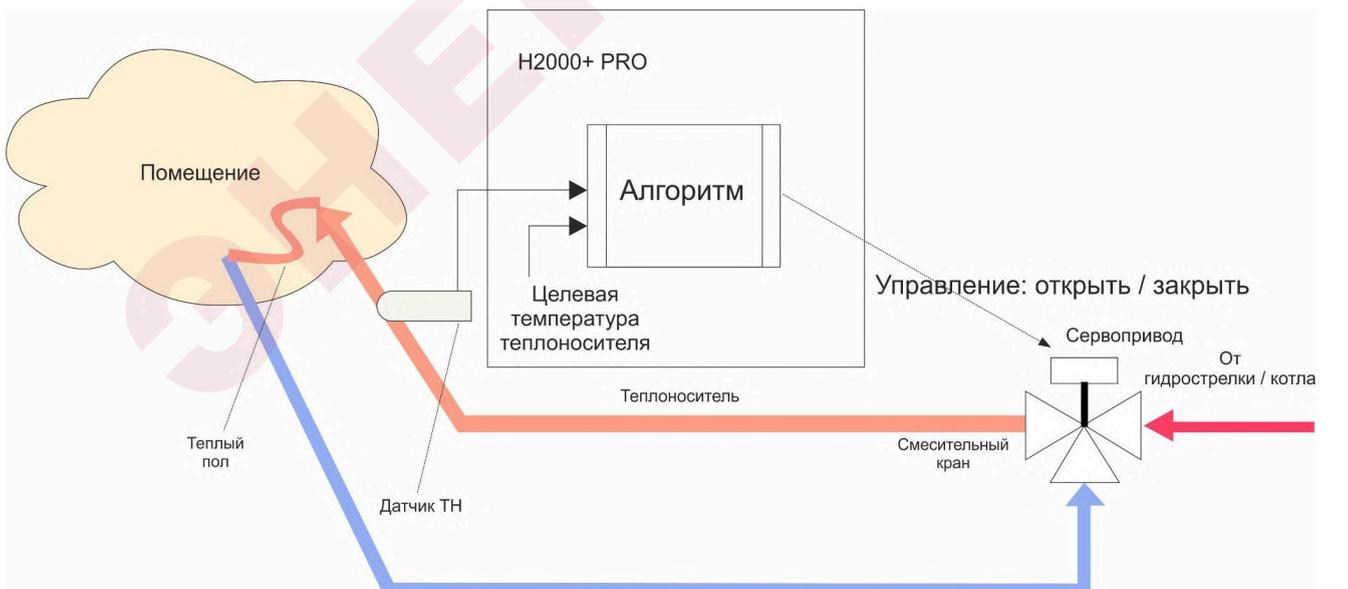
**“Управление по воздуху”** – Контроллер анализирует разницу между Целевой и фактической температурой воздуха в помещении и посылает импульсы управления сервоприводу для движения в нужном направлении.
