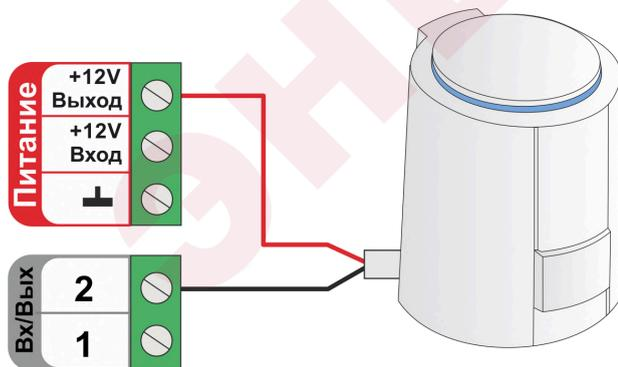
Схема подключения к релейному выходу:
