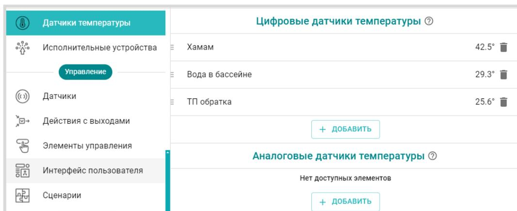
**ВНИМАНИЕ!!!** При подключении аналогового датчика температуры к контроллеру необходимо в настройке сервиса “Аналоговые датчики температуры” указать номер Входа, к которому он физически подключен, и тип подключаемого датчика.
