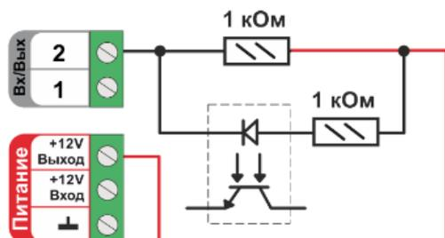
Особенность этой схемы заключается в том, что оптрон может включиться (загорится внутренний светодиод оптрона) даже от малого тока через цепь +3,3 В – 100 КОм – оптрон – +12 В. Чтобы этого не произошло, рекомендуем включить дополнительные резисторы номиналом 1 КОм.
