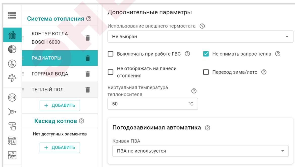
**Использование внешнего термостата** – параметр для настройки контура со сторонним устройством управления с дискретным выходным сигналом. На панели такого контура отображается символ термостата
