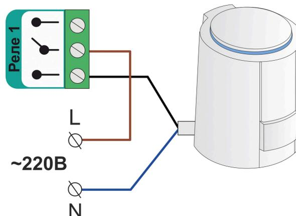
Электроприводы с напряжением питания +12 Вольт можно подключать к выходу ОК, непосредственно к клеммам Контроллера. Но при этом важно учесть, что ток потребления
