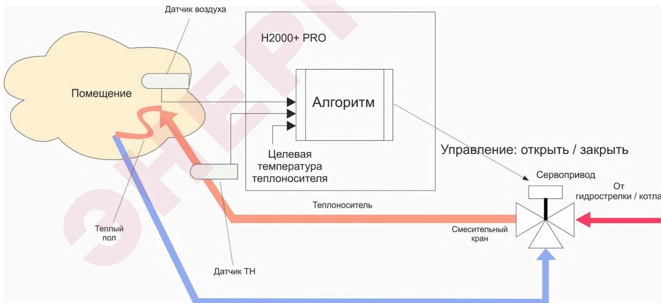
Для такого способа регулирования нужно контролировать два датчика – температуры воздуха в помещении и температуры теплоносителя в контуре за смесительным краном.
