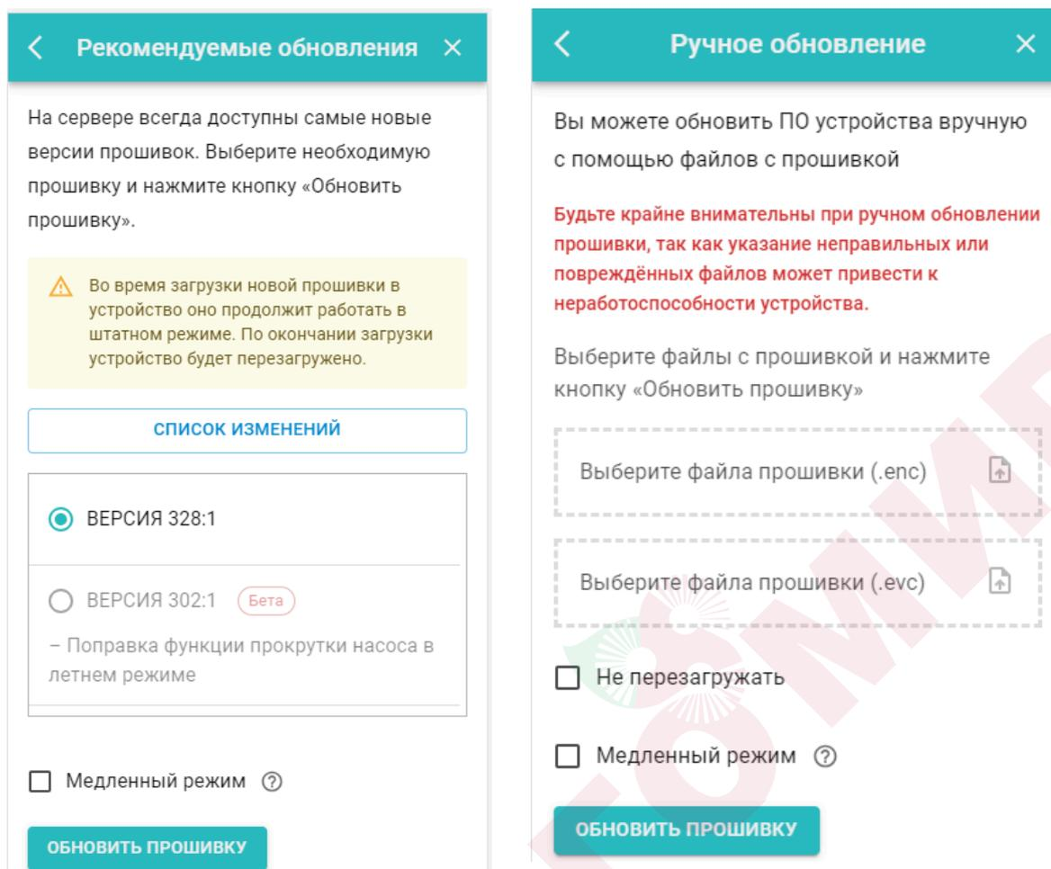
**Примечание:** При обновлении прошивки устройства у которого связь с сервером настроена по сети WI-FI нужно использовать “Медленный режим” обновления.
