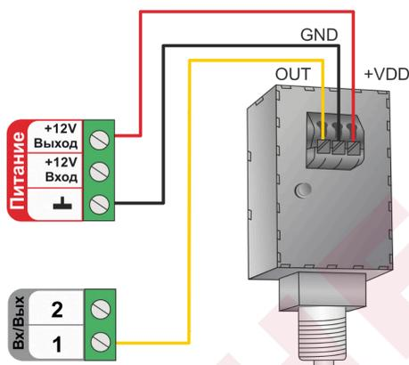
**Примечание:** Тип сенсора входа Контроллера, выбранного для контроля давления должен соответствовать модели подключаемого датчика или указан как “аналоговый вход”.
