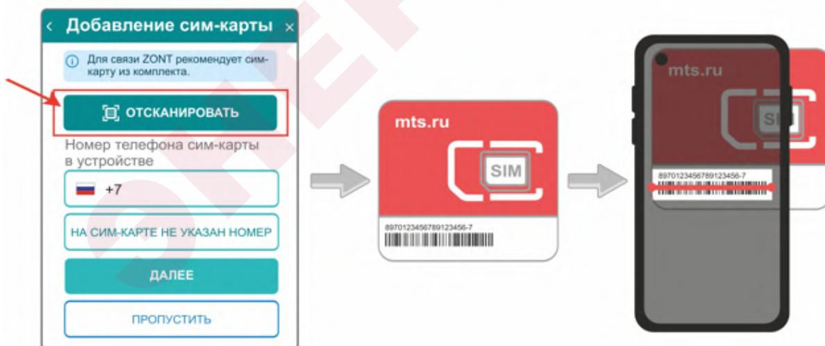
**Примечание:** Сим-карта МТС из комплекта предусматривает выбор из 2-х тарифов и предназначена для применения исключительно в Вашем устройстве. Ее нельзя устанавливать в телефон, планшет или другое устройство ZONT. При попытке использовать не по назначению
