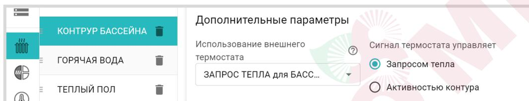
При такой настройке, появление на входе дискретного сигнала, будет формировать “запрос на тепло” котловому контуру, т.е. включать котел в нагрев. **Целевая температура** нагрева теплоносителя задается с панели контура на вкладке “Отопление”.
