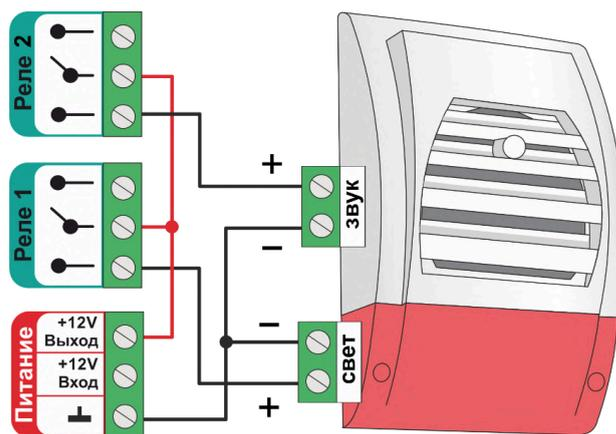
**Примечание:** В неактивном состоянии выхода ОК из-за утечки тока при подключении нагрузки с высоким сопротивлением, у некоторых типов светозвуковых оповещателей (например МАРС-12 КП), может наблюдаться слабое свечение светодиода и треск или писк динамика. Для решения проблемы рекомендуется выполнять подключение оповещателя через промежуточное реле.
