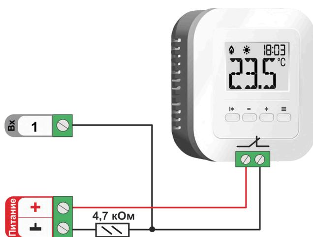
**Примечание:** Перед подключением комнатного термостата обязательно выясните каким образом (замыканием или размыканием контактов) термостат подает сигнал запроса тепла.
