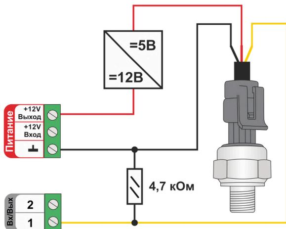
**Примечание:** Резистор подтяжки номиналом 4,7 кОм. устанавливается только если входу контроллера, к которому подключен датчик давления, настройкой назначен оригинальный тип сенсора. В этом случае при “обрыве датчика” формируется соответствующее событие. Если тип сенсора назначен “аналоговый вход” - резистор не нужен.
