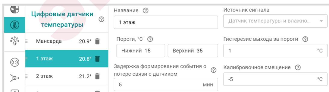
Датчик температуры и влажности МЛ-779 определяется автоматически только как датчик температуры. Для контроля влажности, датчик должен быть выбран вручную на вкладке
