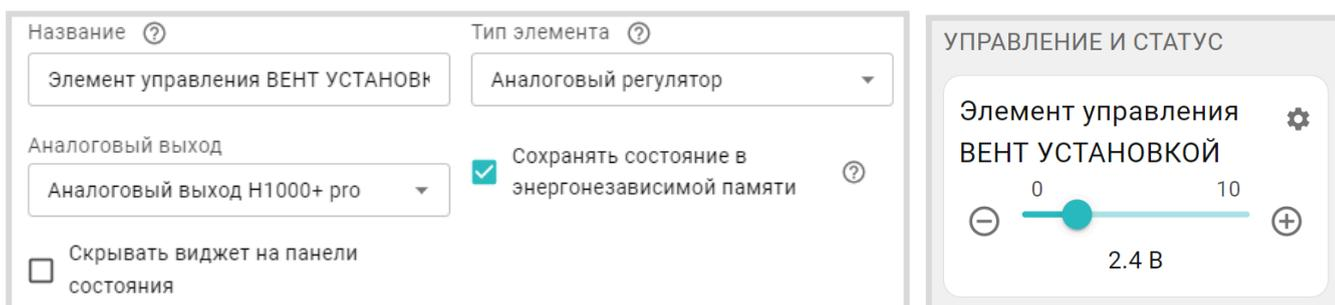
При этом в блоке Управление и Статус будет отображен Элемент управления аналоговым выходом 0-10В. Перемещая ползунок шкалы напряжения, можно менять напряжение на аналоговом выходе и тем самым управлять работой исполнительного устройства вручную.
