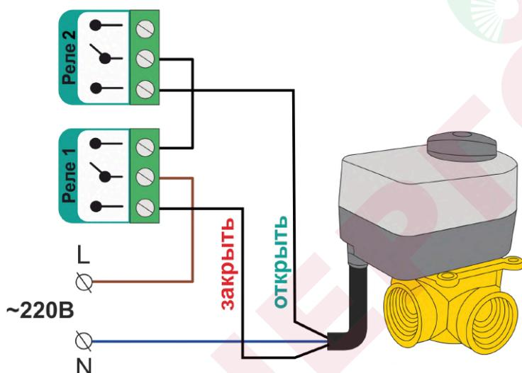
Схема подключения электропривода к выходам ОК через промежуточные реле с защитой от одновременной подачи напряжения на вывод “открыть” и на вывод “закрывать” привода:
