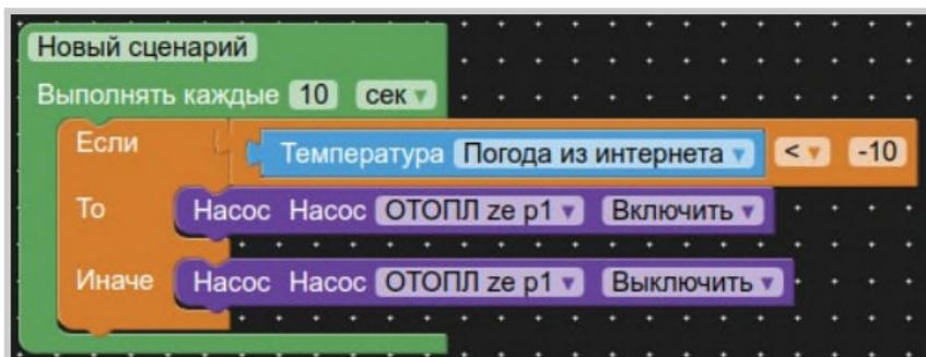
*Пример:* Надо включать насос, только когда температура на улице опускается ниже -10°C. и выключать его когда она выше -10°C.
