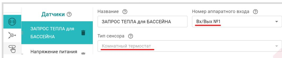
В настройке контура бассейна указать, что “Сигнал термостата управляет **Запросом тепла**”
