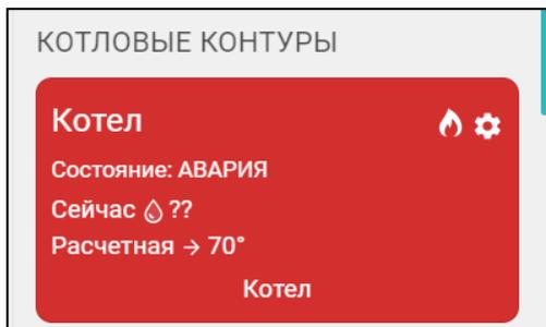
В окне детальной информации контура котла появляется код ошибки, который передает котел по цифровой шине, возможная причина ошибки и метод ее устранения.
