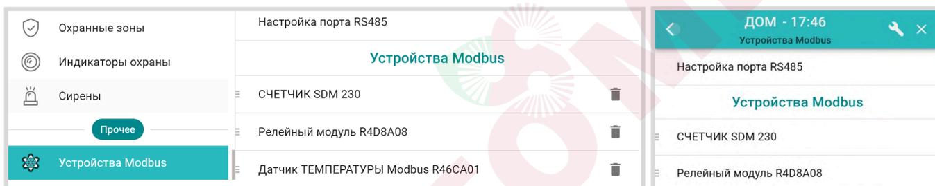
Включение режима Modbus автоматически исключает возможность использования в конфигурации Контроллера оригинальных цифровых устройств ZONT подключенных к шинам RS-485 и K-Line.
