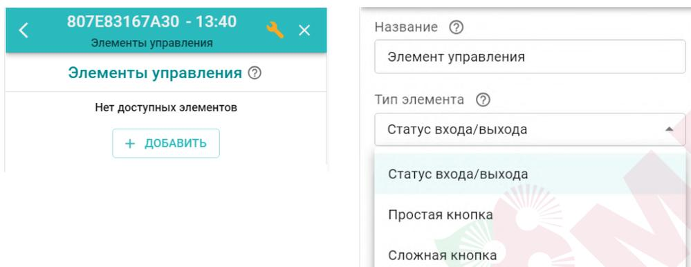
Элемент управления может быть “Статусом входа или выхода” и отображать текущее состояние универсального входа или релейного выхода Контроллера, или может быть “Простой” или “Сложной” кнопкой и управлять выходами Контроллера.
