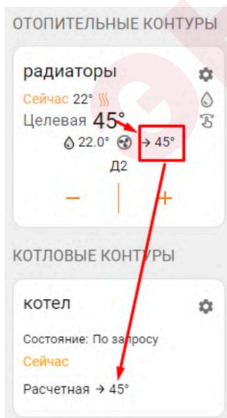
В результате такой настройки “запрос на тепло” к котловому контуру из расчетной температуры теплоносителя будет преобразован в управляющее напряжение и через аналоговый выход поступит на аналоговый вход 0-10 В котла.
