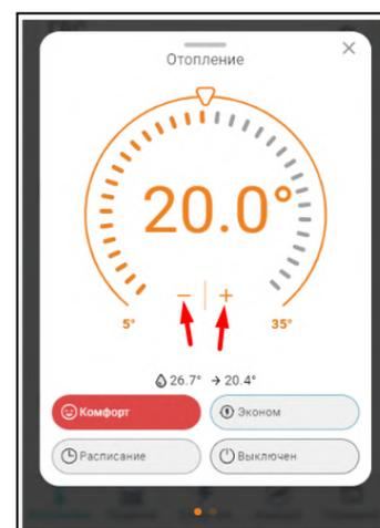
Если в процессе эксплуатации возникает необходимость применения другой кривой ПЗА, то для этого достаточно изменить целевую температуру воздуха в панели этого контура отопления в большую или меньшую сторону относительно предустановленных **20°C**.
