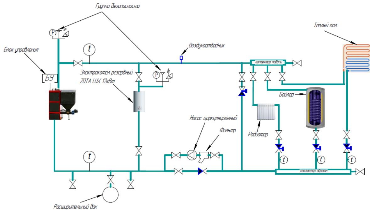
Рисунок 6 — Типовая схема обвязки автоматического котла
