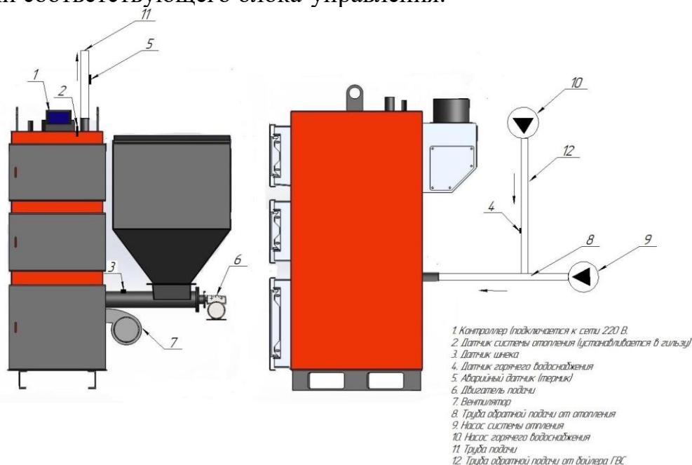
*Рисунок 9 — Схема подключения блока управления к котлу*
