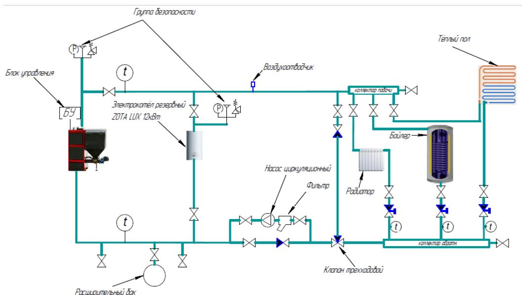
Рисунок 7 — Схема обвязки автоматического котла с трехходовым клапаном
