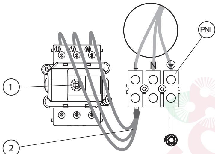
Для подключения к трехфазной электрической сети (для котлов мощностью 4, 6, 8 кВт) необходимо отъединить провода ② и переключить переключатель №3 в положение ON стр.7)
