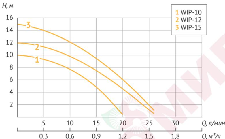
Приведённые данные по максимальному напору и максимальной производительности справедливы при напряжении электросети 220 В.
