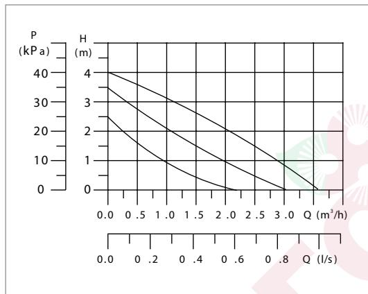
Рис. 1. Рабочее поле для насосов **TL 25-40, TL 32-40** (230 В ~ 50 Гц)
