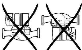
Рис. 3. Положения насоса при монтаже
