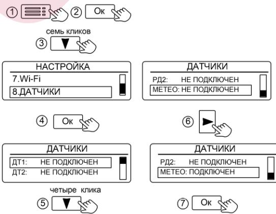
Рисунок 24. Настройка подключения к метеосерверу.
