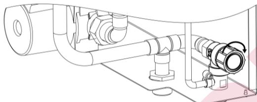
Рисунок 34. Поворот крышки клапана
