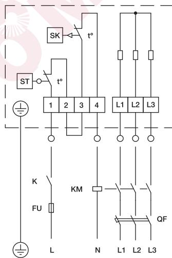
SK — термостат защиты от перегрева с автоматическим возвратом, температура срабатывания 60 °C;
