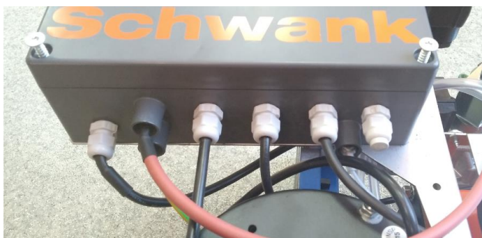
Рисунок 4.4.1 Внешний вид устройства розжига и контроля горения
