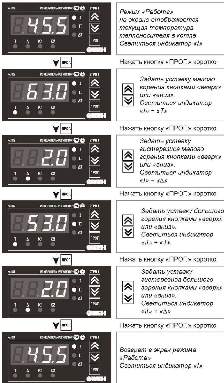
Рисунок 22. Изменение уставок малого и большого горения котла
