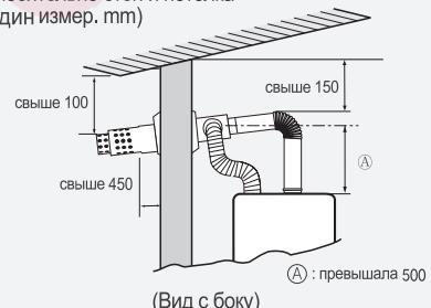
■ Не допускайте соединения гофры подачи воздуха в нижней части дымохода,
