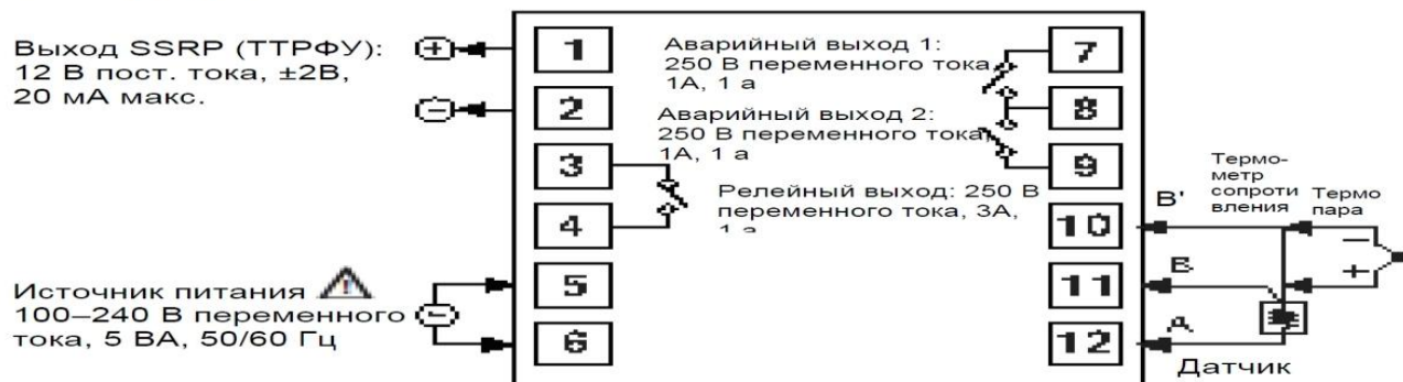
Рис. 9. Электрическая схема температурного контроллера.
