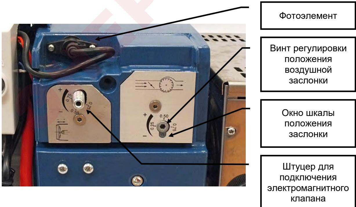
Рис. 5. Заслонка вторичного воздуха и фотоэлемент
