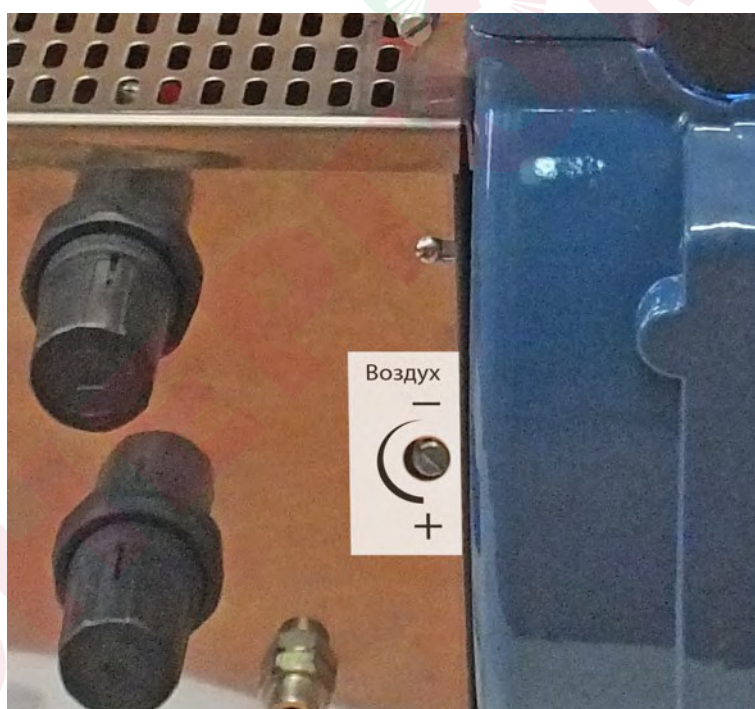
Рис. 5. Заслонка вторичного воздуха
