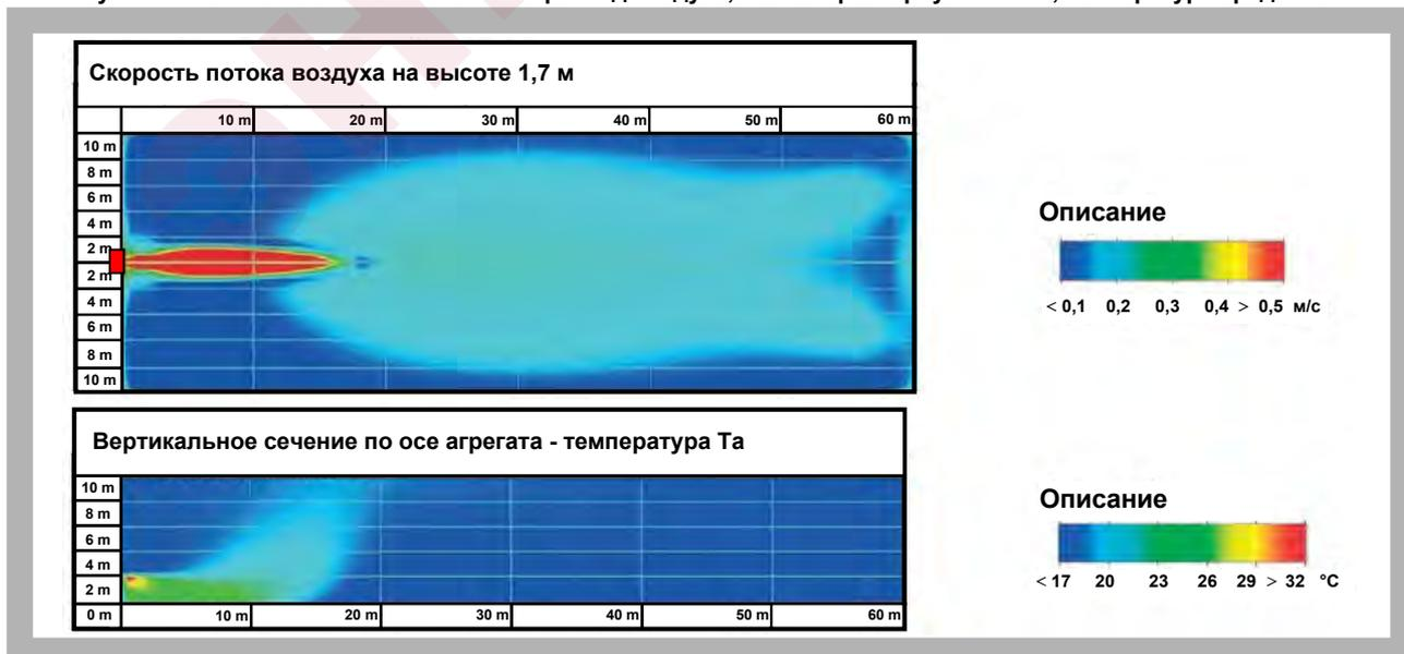
Рисунок 17. MONZUN 350 - Максимальный расход воздуха, жалюзи развернуты на 45°, температура среды 18°C
