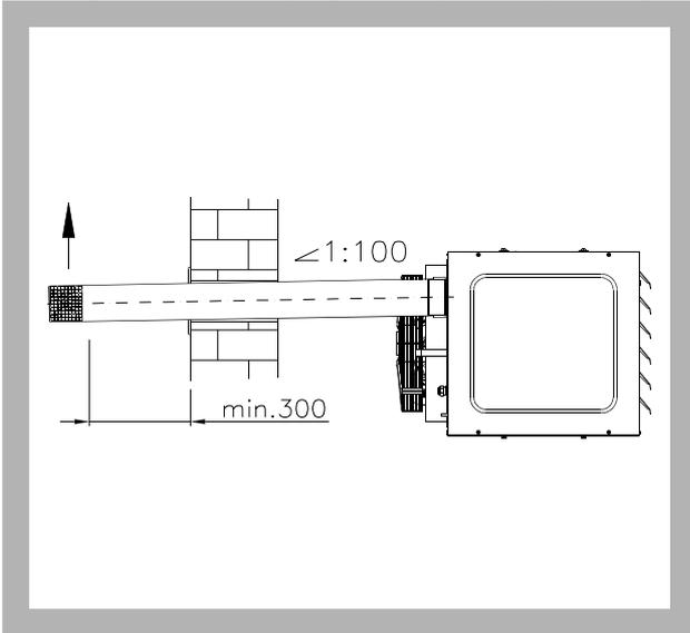
Рисунок 28. Отвод продуктов сгорания через стену с RKN
