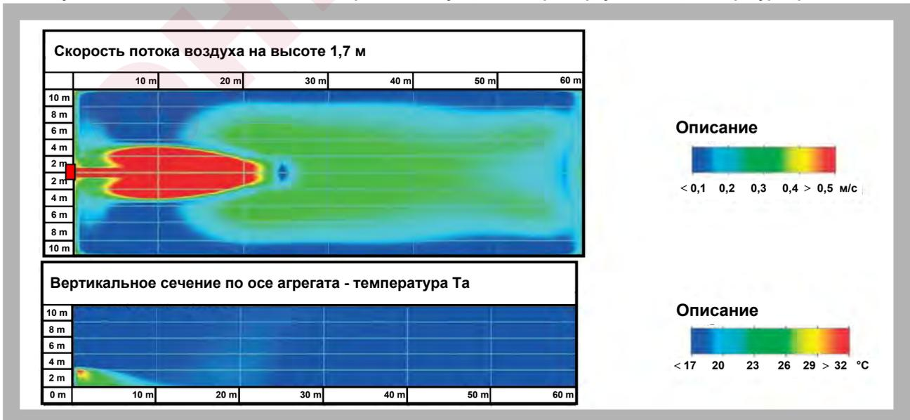
Рисунок 20. MONZUN 520 - Максимальный расход воздуха, жалюзи развернуты на 45°, температура среды 18°C
