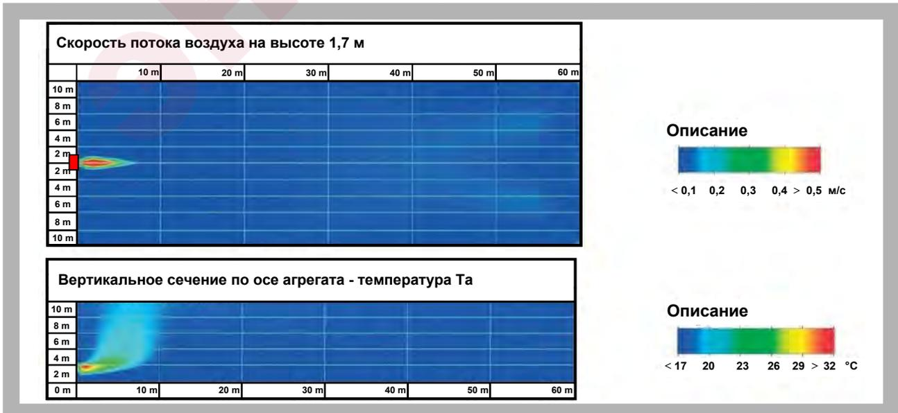
Рисунок 14. MONZUN 180 - Максимальный расход воздуха, жалюзи развернуты на 45°, температура среды 18°C
