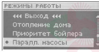
В этом режиме работа насосов начинается параллельно выше предела включения насосов (установленный производителем на 40°C). Насос ц.о. работает все время, а насос гор. воды выключается по достижении заданной температуры на бойлере.
