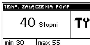
Эта опция используется для настройки температуры включения насосов ЦО и ГВС, температура измеряется в котле. Ниже установленной температуры оба насоса не работают, а выше этой температуры насосы включены и работают в зависимости от режима работы (см. Режим работы насосов).
