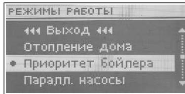
В том режиме включен насос бойлера (гор. воды), до достижения установленной температуры (см. раздел ), по ее достижении насос будет выключен и активируется циркуляционный насос ц.о.
