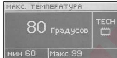
Защита возврата действует таким способом, что если температура на коротком цикле слишком высока, то клапан начинает открываться и распределять воду по установке во избежание опасной температуры, чтобы не допустить до повреждения котла.
