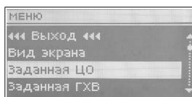
Этот режим служит для установки заданной температуры котла. Пользователь может изменять диапазон температуры на котле от 45°C до 85°C. Заданную темп. ц.о. можно также изменить непосредственно с главного экрана контроллера, поворачивая регулятор импульсатора.
