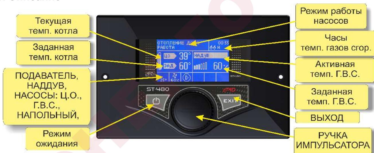
Регулятор температуры ST-480zPID предназначен для котлов ц.о. и управляет насосом циркуляции воды Ц.О., насосом горячего водоснабжения ГВС, клапаном-смесителем и вентилятором. Дополнительно есть возможность управлять еще двумя клапанами-смесителями посредством модулей ST-61.
