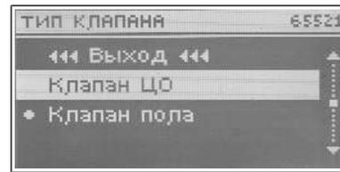
При помощи этой функции пользователь выбирает вид применяемого клапана: Ц.О. или напольный. **8.**
