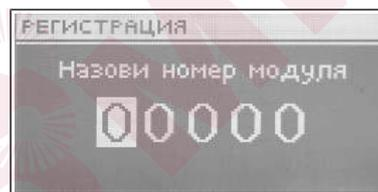
Чтобы зарегистрировать дополнительный клапан, следует вписать серийный номер модуля, управляющего сервомотором смешивающего клапана ST-61 (это пятизначный номер, находящийся на корпусе этого модуля). Без этого номера клапан нельзя активировать.
