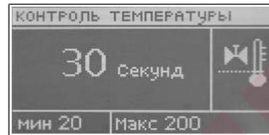
температуры (отклонение от заданной), то электроклапан приоткрывается или прикрывается на установленный шаг, чтобы достичь заданной температуры.
