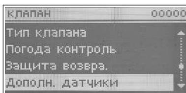
В случае применение двух смешивающих клапанов следует выбрать, будет для считываться измерение для датчика возврата и наружного датчика со второго модуля клапана, или с выхода настраиваемого модуля – собственные датчики).
