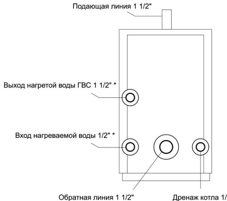
Рисунок 3. Схема устройства Котлов моделей Р 52-102 в комплектации с опцией ГВС.
