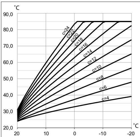
*Коэффициент наклона кривой нагрева*
