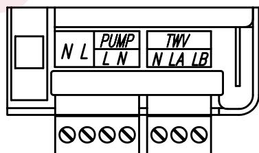
**Комнатный регулятор температуры (контакт RT)** - отсоединение контакта без напряжения отключает отопление. Вход отвечает за управление работой котла в зависимости от температуры в помещении. Способ подключения описан в разделе Монтаж, п.7.
