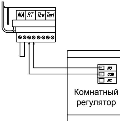
NA - место подключения приоритетного прибора (фабричная установка)
