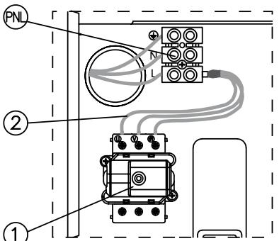
**Подключение котла к однофазной электросети (касается котлов мощностью 4кВт, 6кВт и 8кВт).**
