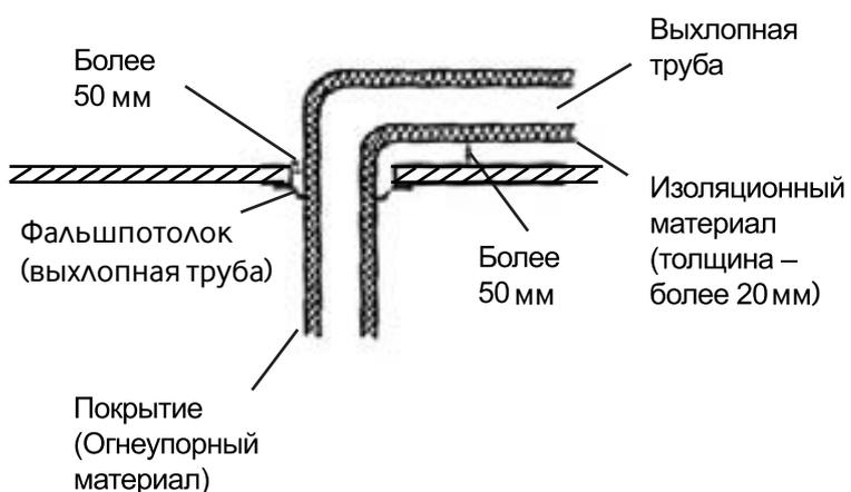
**Внимание!** Дымоотводящие трубы устанавливаются только по проекту газификации. Запрещается подключать к дымовой трубе котла любой другой тип оборудования (включая использующие другие типы топлива, например брикетированный уголь). Запрещается отвод дымовых газов в вентиляционные каналы.
