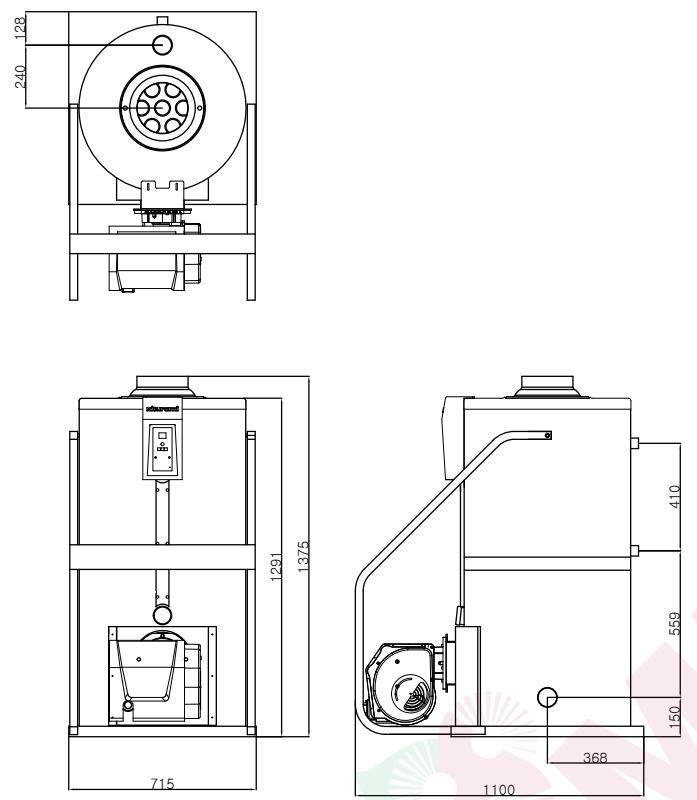
Рисунок 19. Габаритные и присоединительные размеры котлов КСО-100
