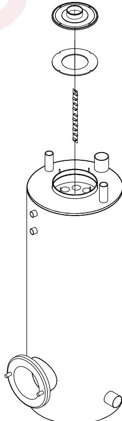
Рисунок 1. Схема доступа к жаротрубным каналам
