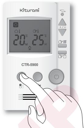
2. Нажатием кнопок Вверх(▲)/Вниз(▼) установите желаемую температуру в помещении (котел работает только в том случае, если устанавливаемая температура выше температуры в помещении, указанной на дисплее).
