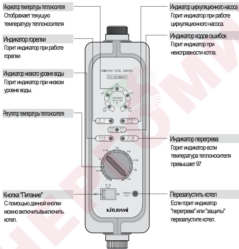
Рисунок 11а. Блок управления КСО- 200
