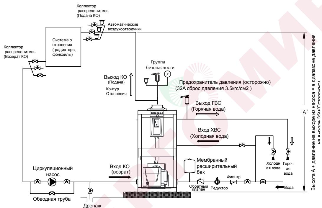
Применение котла допускается в любой системе отопления , открытого или закрытого типа , при соблюдении общепринятых правил проектирования систем отопления.
