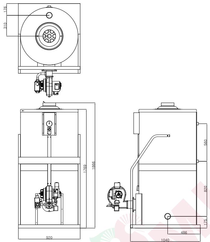
Рисунок 21. Габаритные и присоединительные размеры котлов KSO-200
