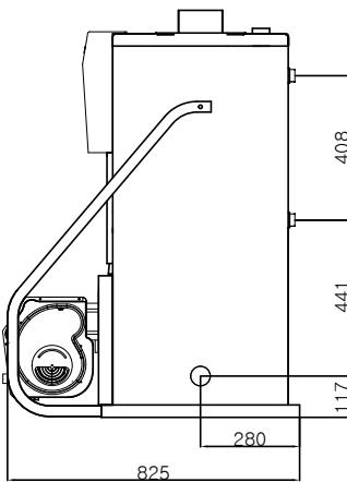
Рисунок 18. Габаритные и присоединительные размеры котлов КСО-70
