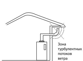
Если в пределах 1 м от дымовой трубы находится высокое здание рекомендуем устанавливать трубу выше 1 м от крыши высокого здания
