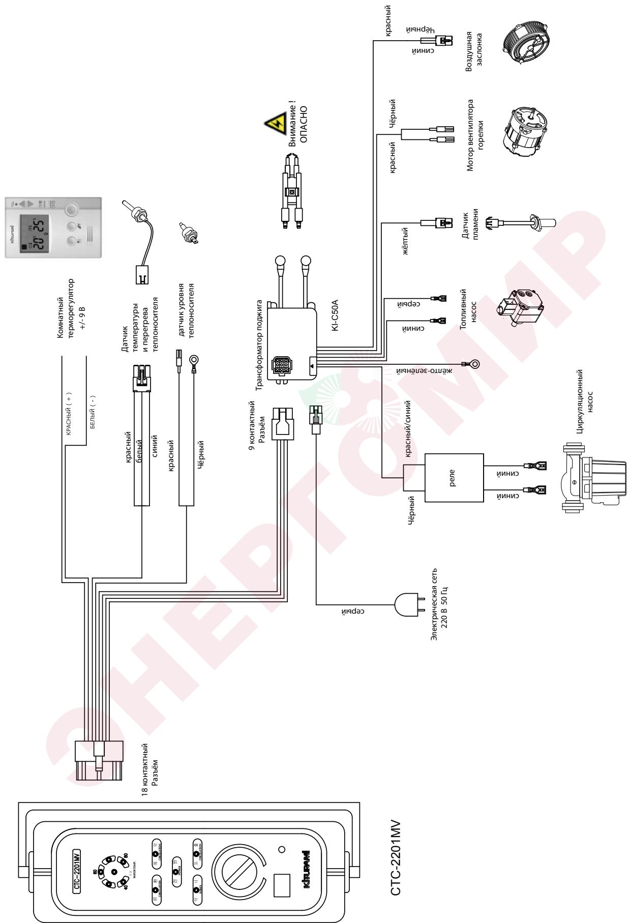
Рисунок 9. Схема электрическая для котлов КСО -200
