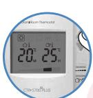
8. Если после установки желаемой температуры в помещении загорается лампочка-индикатор включения, значит, котел работает в нормальном режиме.
