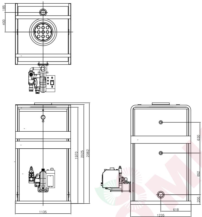
Рисунок 23. Габаритные и присоединительные размеры котлов КСО-400
