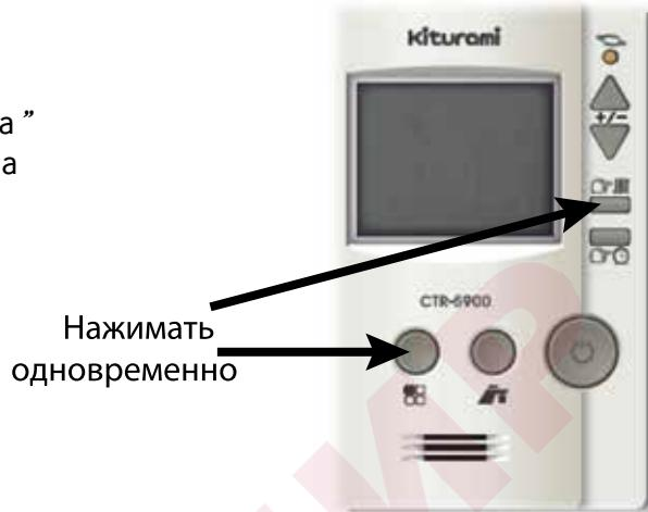
2. Нажатием кнопок Вверх(▲)/Вниз(▼) установите необходимый режим управления работой котла : “set 1” - соответствует режиму управления по температуре воздуха в помещении , “set 2” - соответствует режиму управления по температуре теплоносителя .
