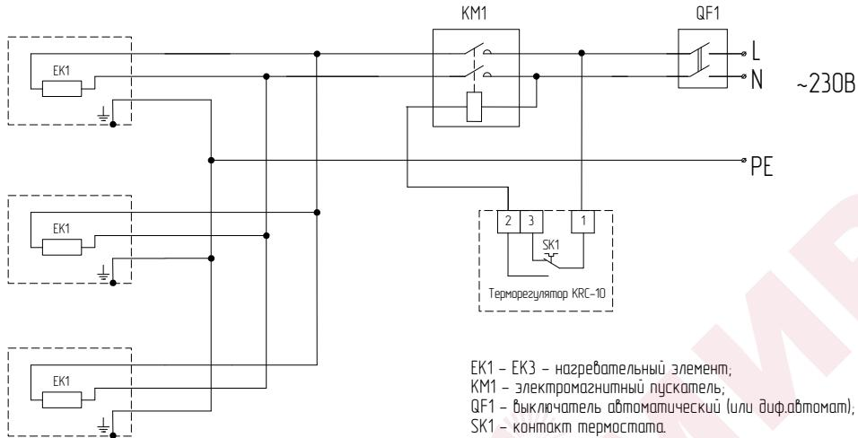
Рис. 1 Обогреватель для KIRH-E06P-11, KIRH-E08P-11, KIRH-E08P-12, KIRH-E10P-11, KIRH-E10P-12
