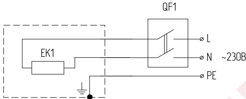
Рис. 1 Обогреватель для KIRH-E06P-11, KIRH-E08P-11, KIRH-E08P-12, KIRH-E10P-11, KIRH-E10P-12
