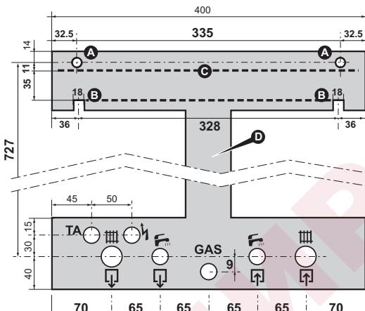
**Примечание:** Как дополнительная опция предлагается специальный металлический шаблон многоразового использования (**D** на рисунке), облегчающий позиционирование точек крепления (с использованием оригинального Комплекта подсоединения). Если не используется металлический шаблон многоразового использования и / или оригинальный Комплект подсоединения, о позиции гидравлических подключений котла можно прочитать в параграфе «Габаритные и присоединительные размеры» на стр. 13.
