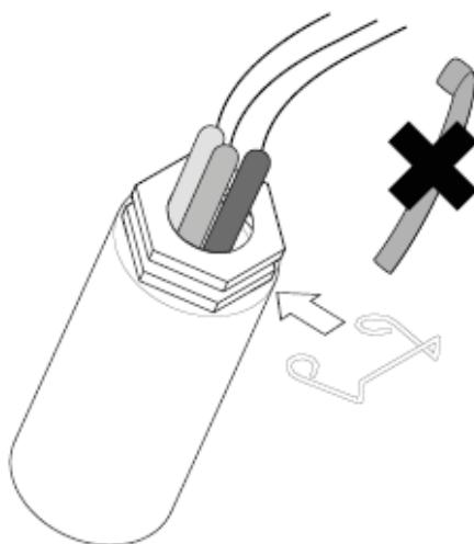
Для достижения теплового контакта необходимо использовать зажим (1), чтобы пропустить медный капилляр (2) внутрь цилиндра (3), привинченного к втулке (4).
