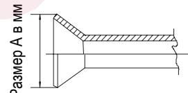
Развальцовку трубы следует выполнять специальным расширительным инструментом для R32. При развальцовке труб с R32 с использованием обычного расширительного инструмента необходимо, чтобы выступ медной трубы за шаблон был в диапазоне от 1.0 до 1.5мм. Также при использовании обычного расширительного инструмента выступающий отрезок трубы рекомендуется отмерять измерительным инструментом для медной трубы.
