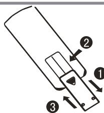
1 Снимите крышку секции батареек, потянув ее в направлении стрелки, как показано на рисунке.
