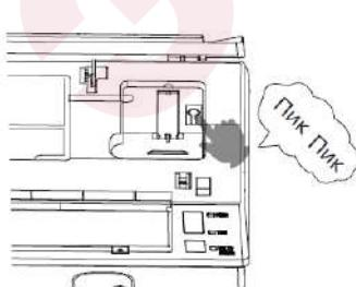
Для выключения кондиционера нажмите на кнопку **EMERGENCY SWITCH**. При этом Вы услышите одиночный звуковой сигнал, подтверждающий выключение кондиционера.
