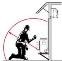
Расположите наружный блок на фундаментном основании и надежно зафиксируйте его с помощью анкерных болтов. При установке блока на стене или поверхности крыши надежно закрепите опору во избежание падения или опрокидывания наружного блока из-за сильного ветра. Блок должен устанавливаться горизонтально.
