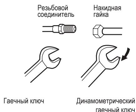
Чрезмерное усилие затяжки при отсутствии центровки может привести к повреждению резьбы и утёчкам хладагента.
