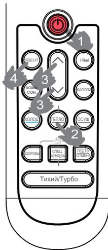
1. Для включения кондиционера нажмите кнопку ON/OFF, кондиционер включится в работу согласно последнему выбранному режиму.
