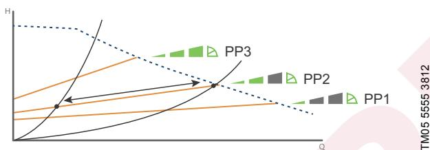
**Рис. 23** Три характеристики/настройки пропорционального регулирования давления
