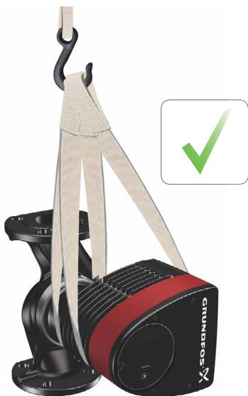
**Рис. 5** Правильный способ строповки насоса
