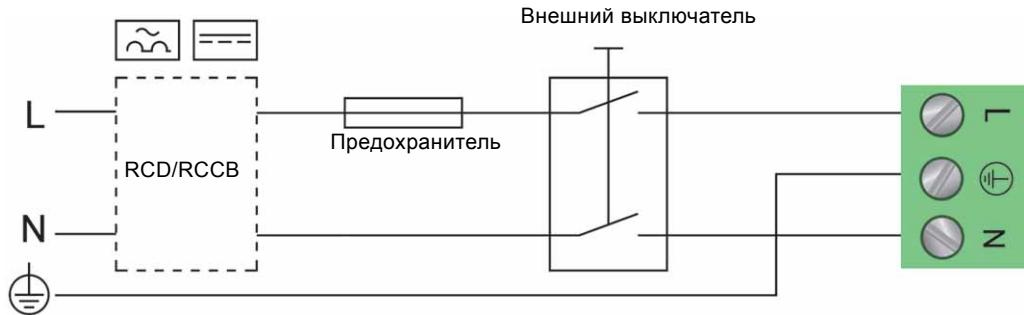
**Рис. 15** Пример подключения к сети электродвигателя с выключателем электропитания, резервными плавкими предохранителями и дополнительной защитой
