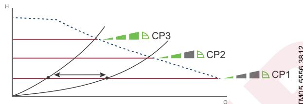
**Рис. 24** Три характеристики/настройки регулирования с постоянным давлением
