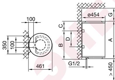
Fig. 1: Instalarea boilerului pe perete în poziție verticală
