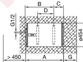
Мал. 2: Монтаж на стіну в горизонтальному положенні
