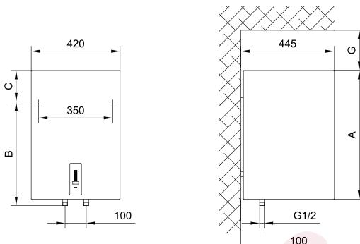
Мал. 1: Вертикальний монтаж на стіну
