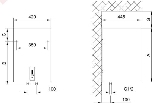
Sl. 1: Vertikalno montiranje na zid
