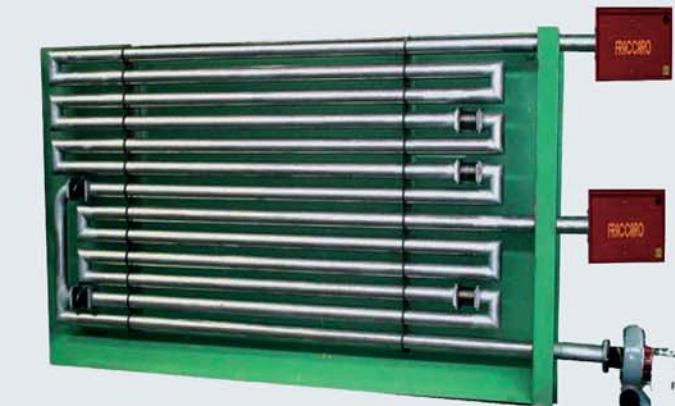
Система подогрева жидкостей для обезжиривания металлических изделий
