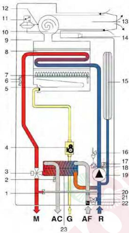
Рис. 7 Гидравлическая схема котла (мод. CTFS)
