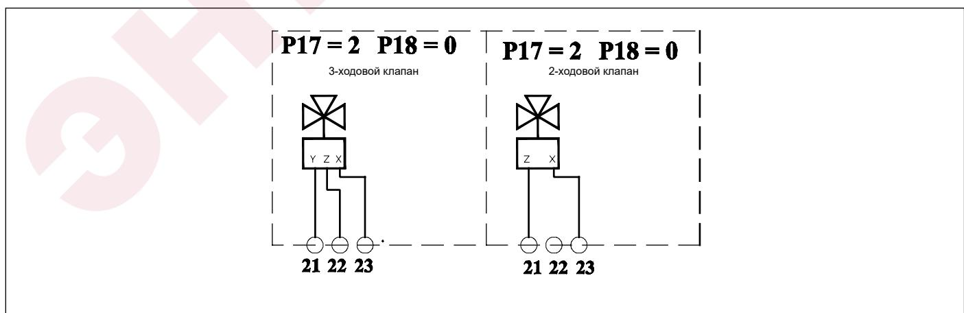
Рис. 37 Схема подключения многофункционального реле ( $X$  = общий;  $Y$  = на котел;  $Z$  = на коллектор)
