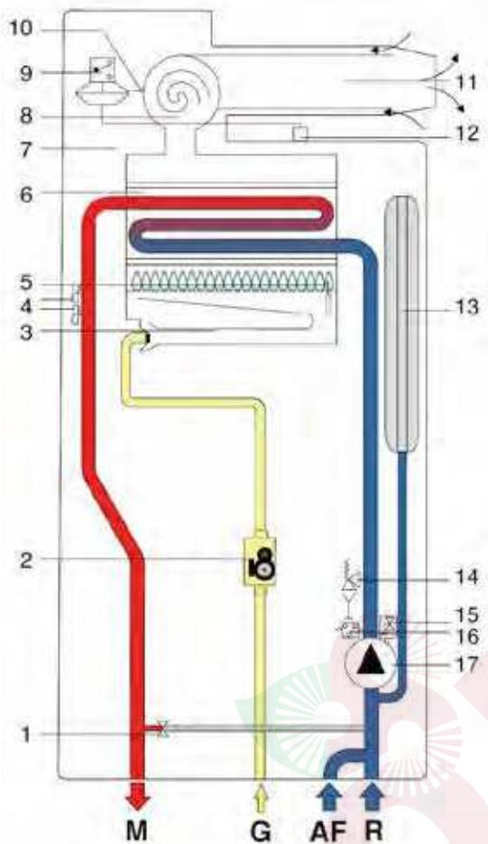
Рис. 9 Гидравлическая схема котла (мод. RTFS)
