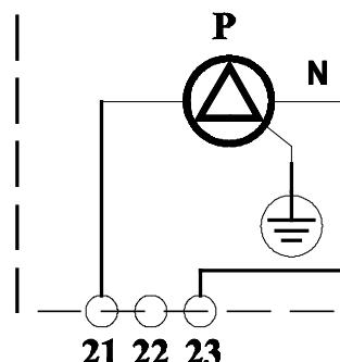
Рис. 39 Схема подключения многофункционального реле
