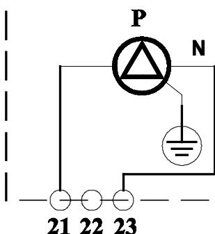
Рис. 35 Схема подключения многофункционального реле
