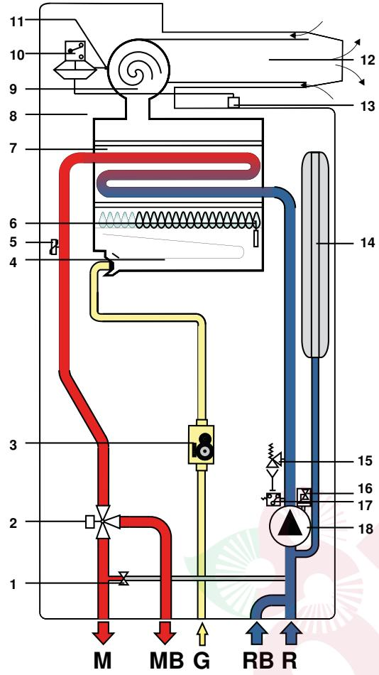
Рис. 11 Гидравлическая схема RBTFS
