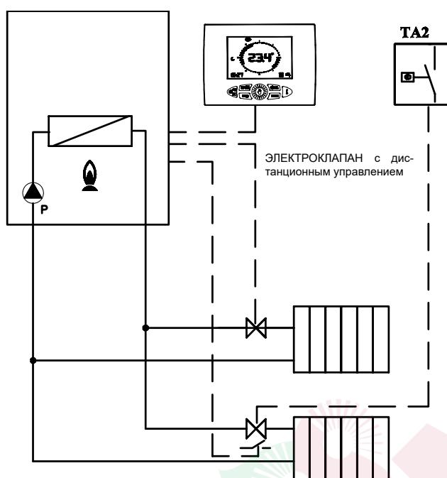
Рис. 40 Работа Реле с пультом ДУ и ТА2
