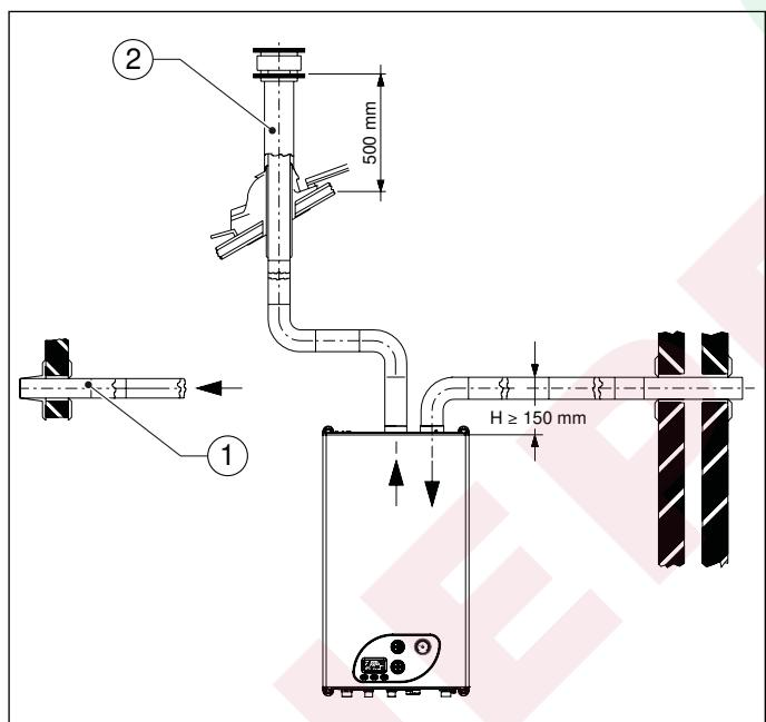
Рис. 18 Примеры системы воздухозабора / дымоотвода
