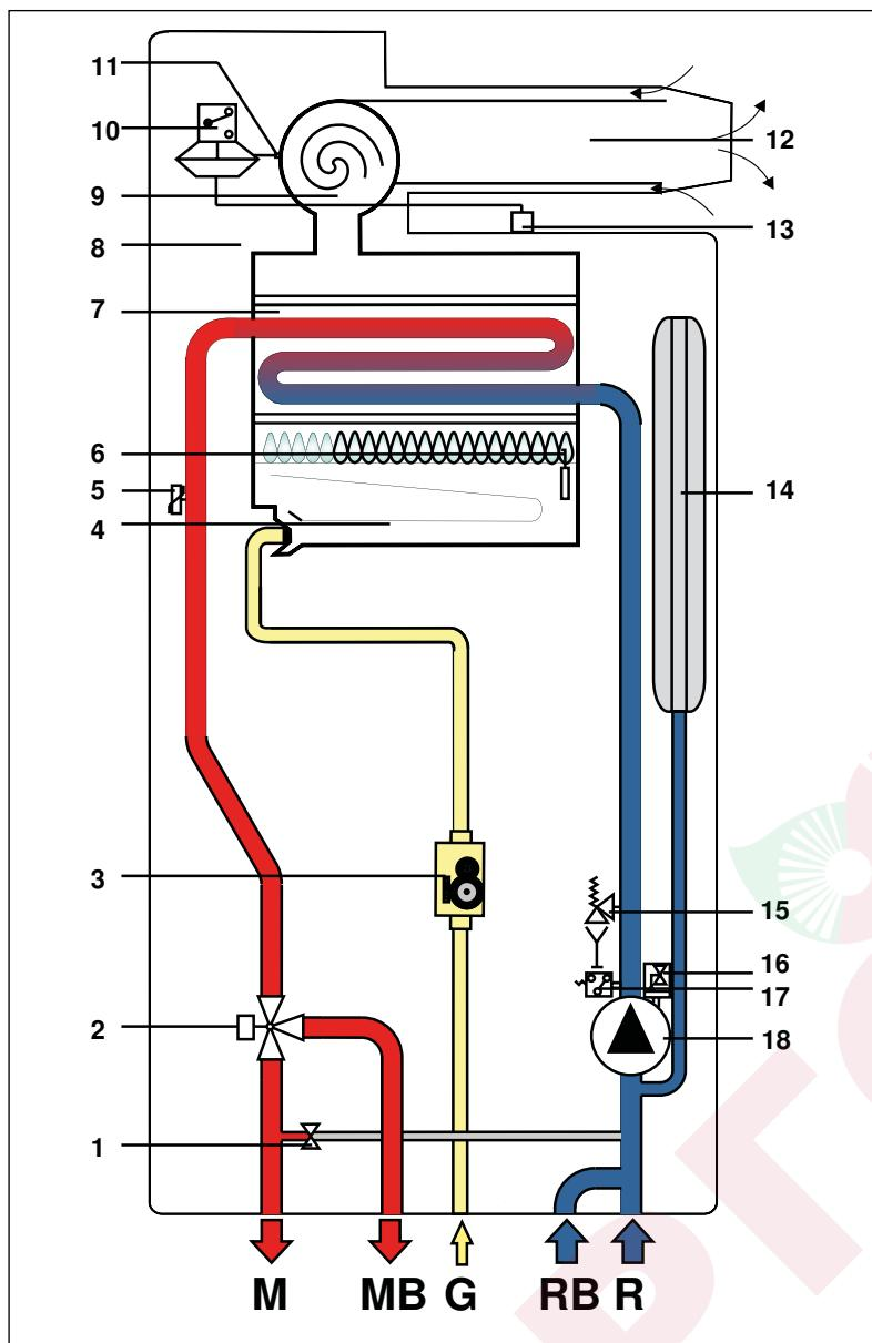
Рис. 7 Гидравлическая схема RBTFS
