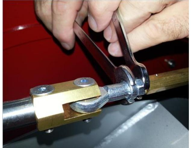
Fig. 46 для регулировки ослабить контргайку
