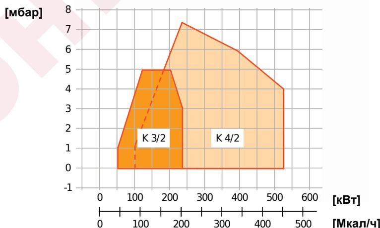
Fig. 1 X = Мощность Y = Сопротивление камеры сгорания
