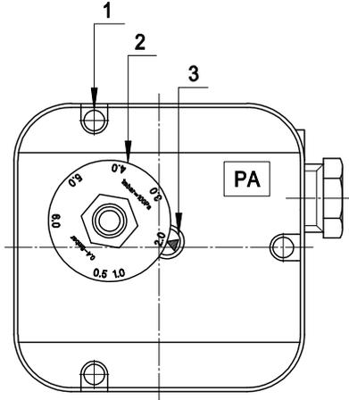
**Fig. 12** 1-Винт заглушка 2-Регулировочная гайка
