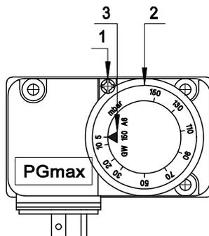
**Fig. 14** 1-Винт заглушка 2-Регулировочная гайка 3-Указатель регулировки 4-Разъем для измерения давления
