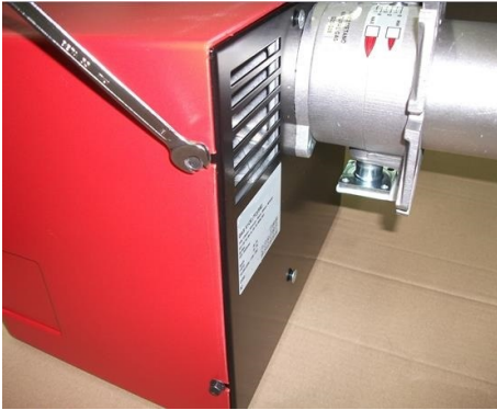
1) Снять кожух, ослабив 4 винта;
