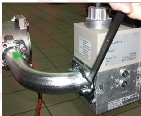
8) установить электроклапан и Прикрепить из фланец;
