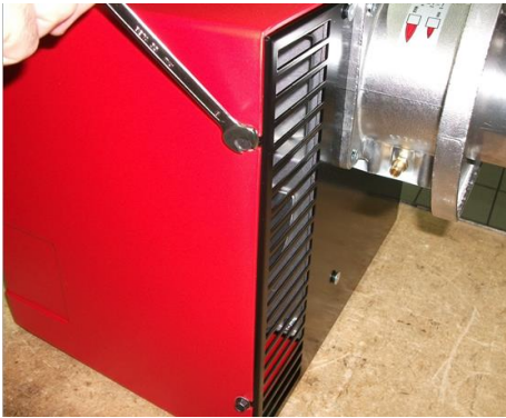
1) Снять кожух, ослабив 4 винта;
