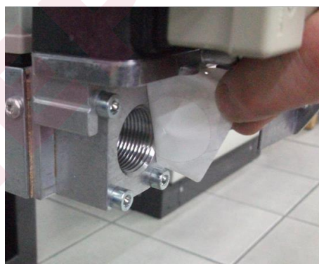
8) Снять заглушку из Труба ГАЗОВОЙ рампы;
