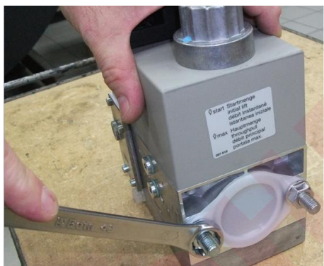
7) Снять заглушку из электроклапан;
