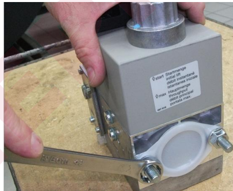
8) Снять заглушку из электроклапан;
