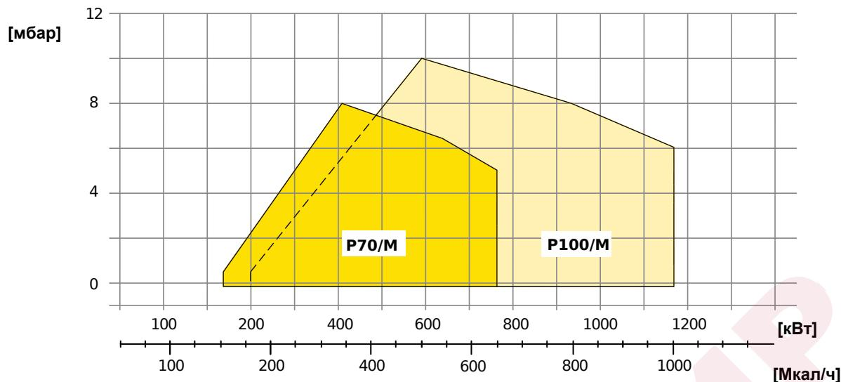
Fig. 1 X = Мощность Y = Сопротивление камеры сгорания
