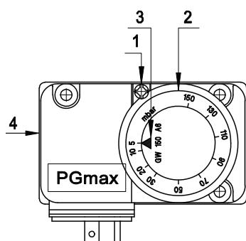
Fig. 13 1-Винт заглушки 2-Регулировочная гайка
