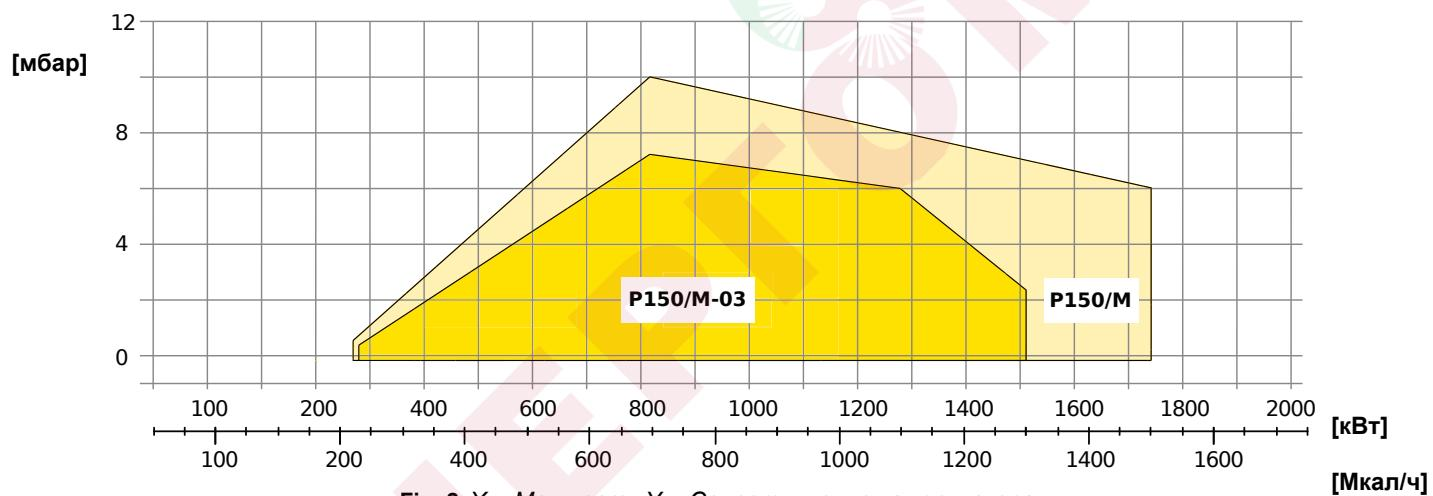
Fig. 2 X = Мощность Y = Сопротивление камеры сгорания
