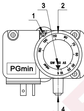
Fig. 12 1-Винт-заглушка 2-Регулировочная гайка
