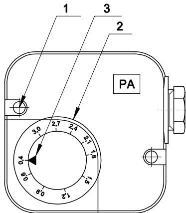
Fig. 11 1-Винт заглушки 2-Регулировочная гайка
