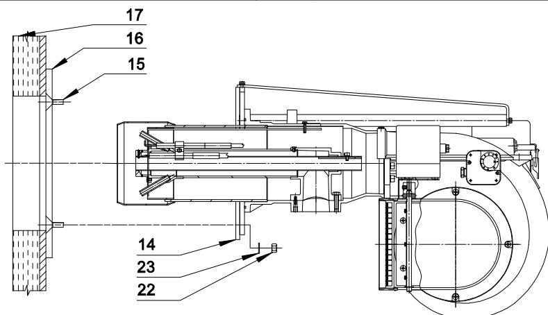
Fig. 5 СХЕМА УСТАНОВКИ ГОРЕЛКИ GAS P70/2CE - GAS P100/2CE - GAS P150/2CE-03 - GAS P150/2CE
