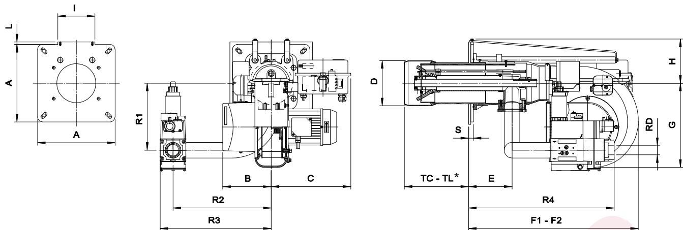
Fig. 3 РАЗМЕРЫ GAS P70/2CE - GAS P100/2CE
