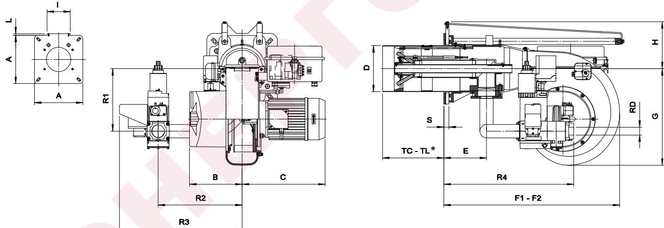
Fig. 4 РАЗМЕРЫ GAS P150/2CE-03 - GAS P150/2CE
