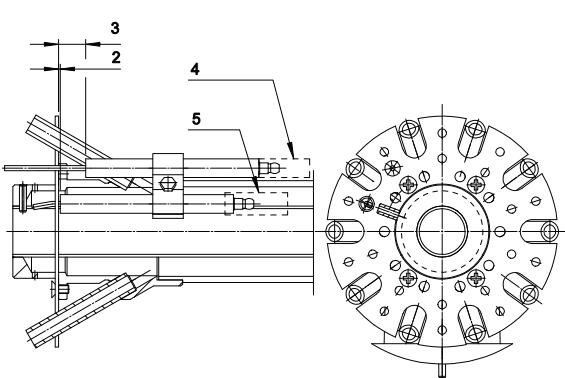
Fig. 18 УСТАНОВКА ЭЛЕКТРОДОВ сжиженный газ
