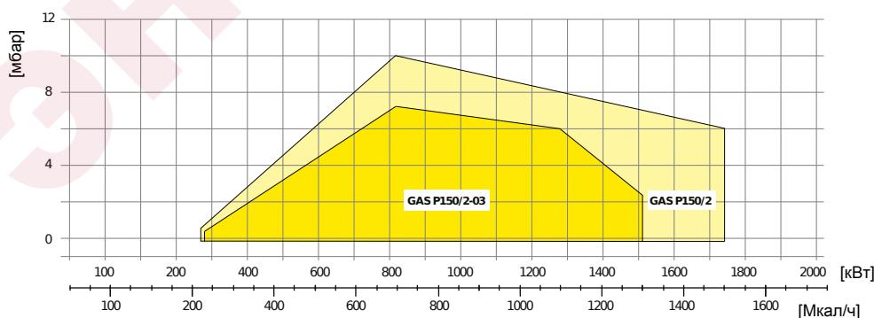
Fig. 2 X = Мощность Y = Сопротивление камеры сгорания
