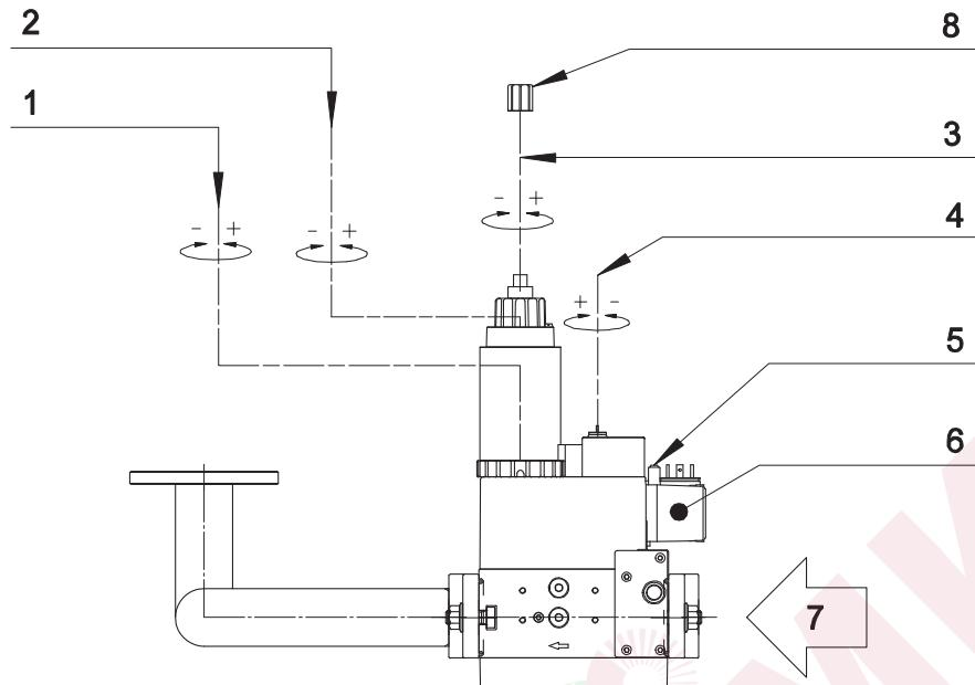
Fig. 15 РЕГУЛИРОВКА ГАЗОВОЙ АРМАТУРЫ МОД.: DUNGS
