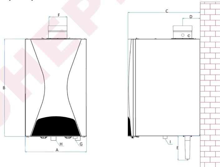
Рисунок 1. Технические размеры
