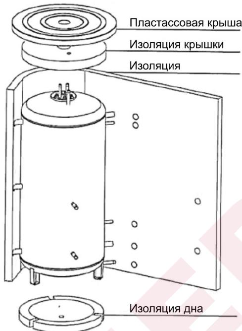
Слой изоляции NEODUL LB PP толщиной 80 мм. Компоненты изоляции - верхняя крышка, крышка фланцев и заглушки отверстий. Изоляция поставляется в отдельной упаковке.
