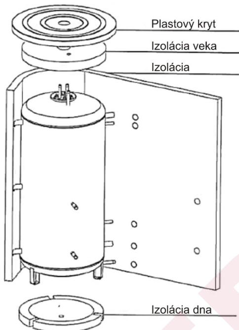
Izolácie NEODUL LB PP s hrúbkou 80 mm. Súčasťou sú horný kryt, kryt prírub a kryty otvorov. Izolácia sa dodáva samostatne zabalená.
