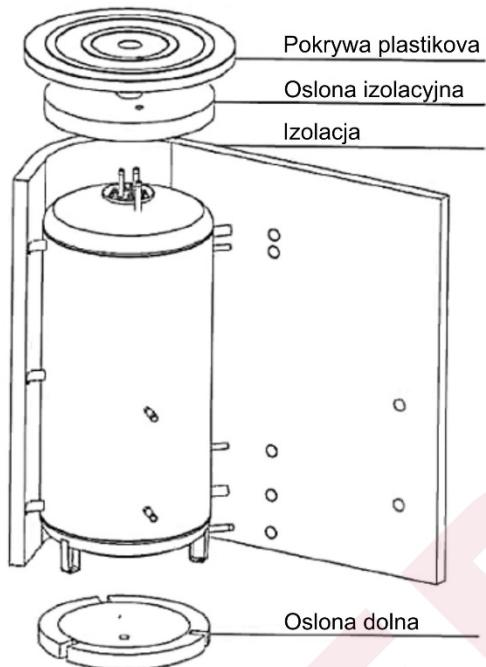
Izolacja NEODUL LB PP o grubości 80 mm. Część składową tworzy pokrywa górska, pokrywa kołnierzy oraz pokrywki otworów. Izolacja dostarczana jest w osobnym opakowaniu.
