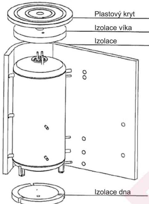
Izolace NEODUL LB PP o síle 80 mm. Součástí jsou horní kryt, kryt přírub a krytky otvorů. Izolace se dodává samostatně zabalena.
