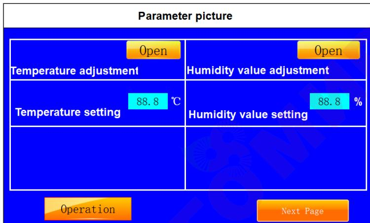
На этом экране задаются уставки температуры воздуха регенерации (Temperature adjustment) и необходимой относительной влажности воздуха (Humidity value adjustment).
