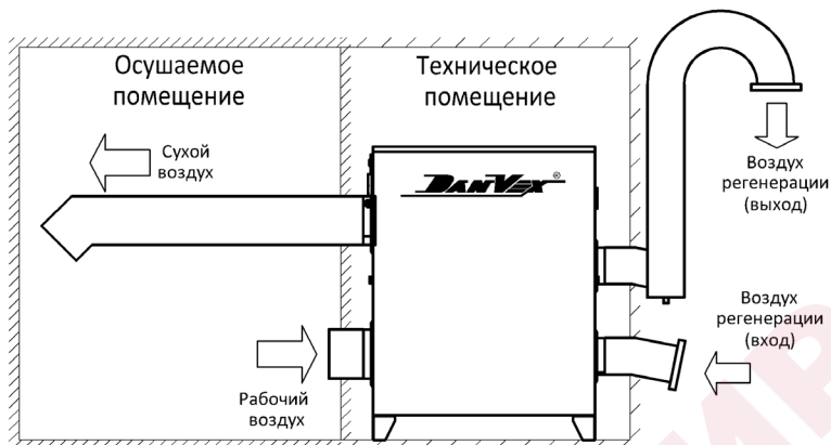
Схема монтажа за пределами контура осушения
