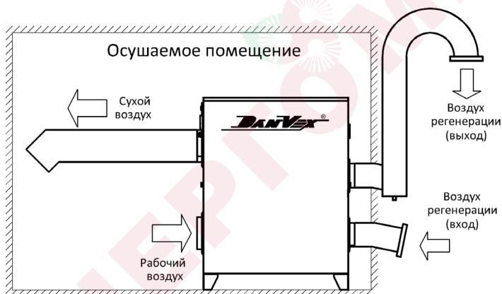
Схема монтажа внутри контура осушения
