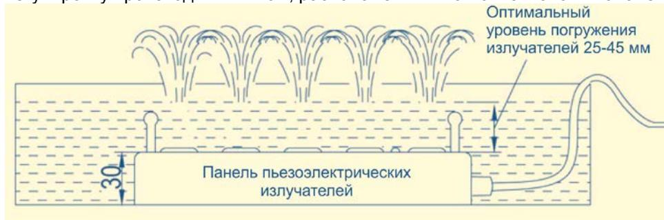
Рис. Расположение панели с излучателями относительно поверхности воды
