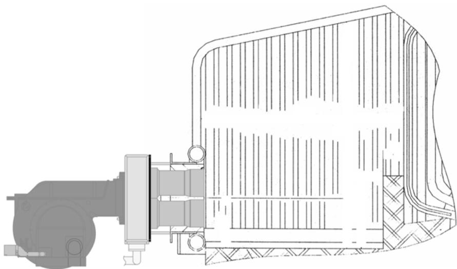
**ВНИМАНИЕ:** уделить особое внимание монтажу горелки: все сопла должны входить вовнутрь камеры сгорания, должны выходить за пределы внутренней части передней стенки котла. Горелка открывается с помощью специального шарнирного соединения правого/левого: оставить свободное место, необходимое для открытия воздушного короба.
