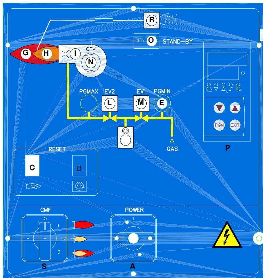
Рис. 15 - Передняя панель электрощита горелки
