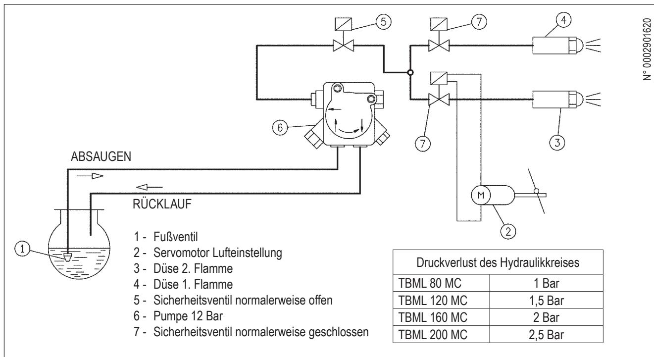
**DIMENSIONIERUNGSPLÄNE DER ROHRLEITUNG TBML 80 MC**
