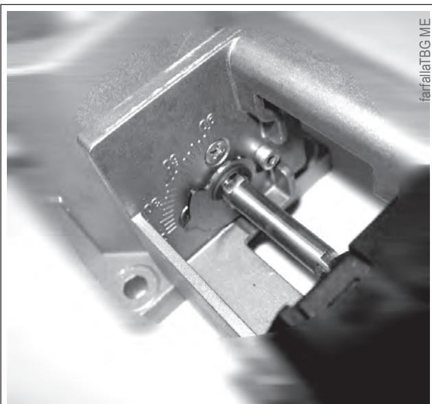
A Referenzpunkt zur Positionierung des Drosselventils.
