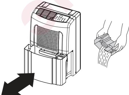
1. При заполнении бака загорается индикатор FULL WATER. Прибор отключается.
