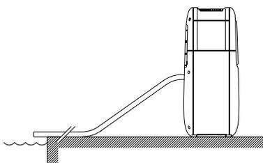
Для непрерывного отвода конденсата используйте шланг внутренним диаметром 16 мм.
