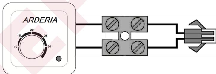
Рис. 47 Подключение комнатного термостата к клеммной колодке.
