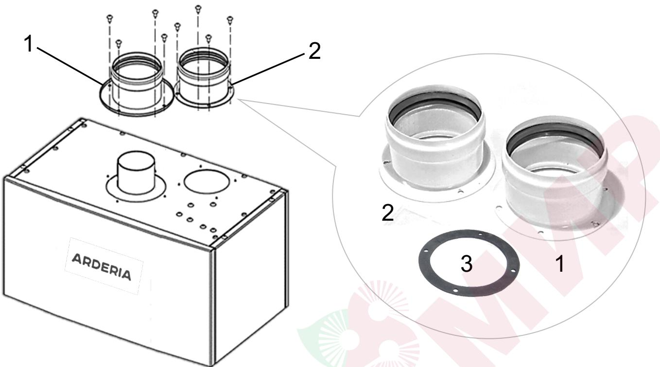
Рис. 33 Установка присоединительных фланцевых элементов для подключения раздельной системы дымоудаления Ø 80x80 мм.
