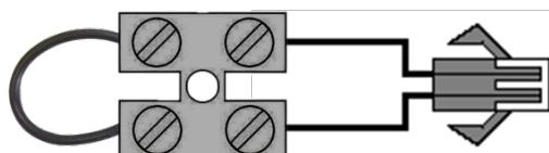
Рис. 48 Подключение перемычки (шунта) к клеммной колодке.
