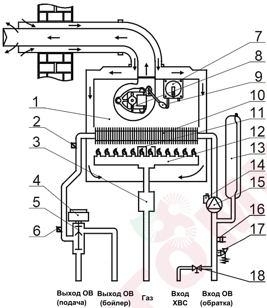
Рис. 3 Функциональная схема котла серии Arderia S.
