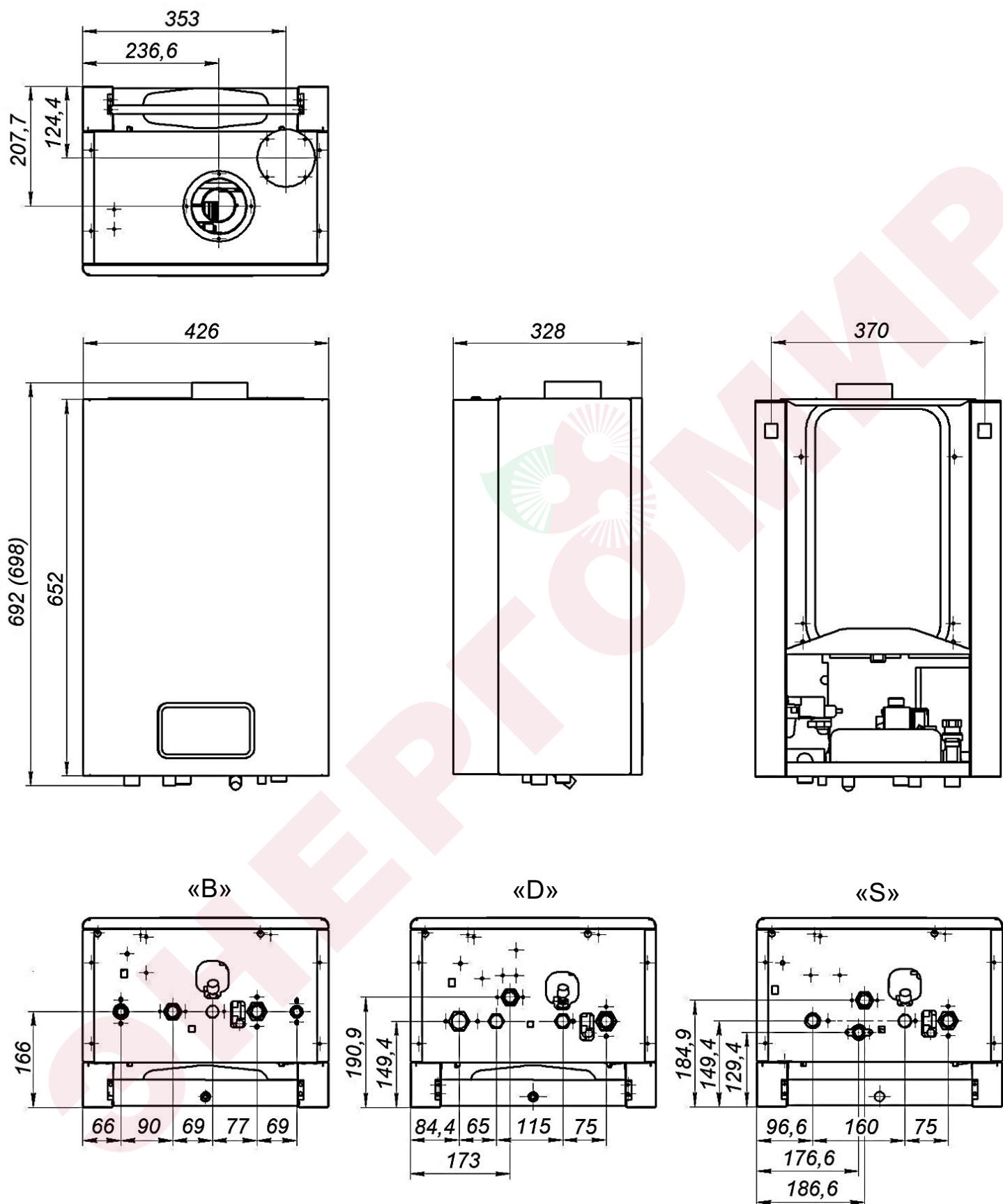
Рис. 6 Габаритные размеры моделей
