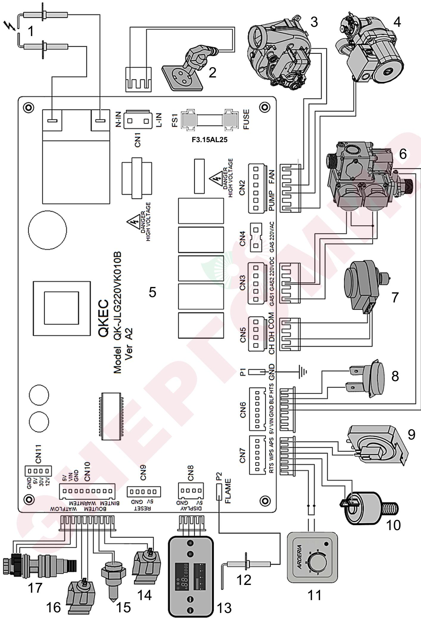
Рис. 42 Принципиальная электрическая схема котлов Arderia D / Arderia B.
