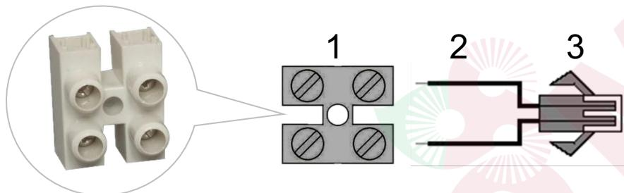
Рис. 46 Подключение клеммной колодки к разрезанным проводам перемычки.
