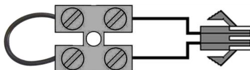
Рис. 47 Подключение перемычки (шунта) к клеммной колодке
