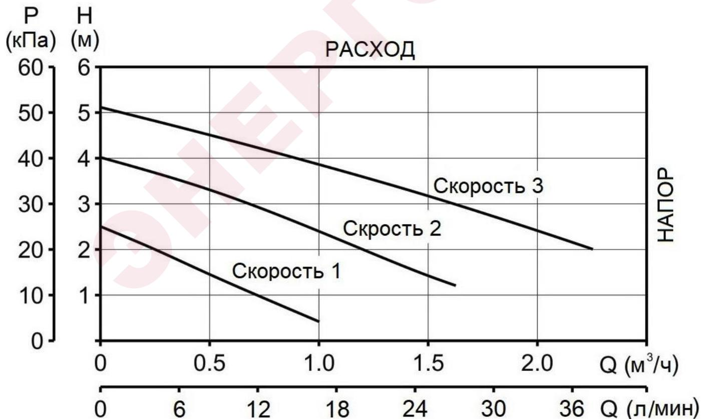
Рис. 23 Напорно-расходные кривые циркуляционного насоса котла.
